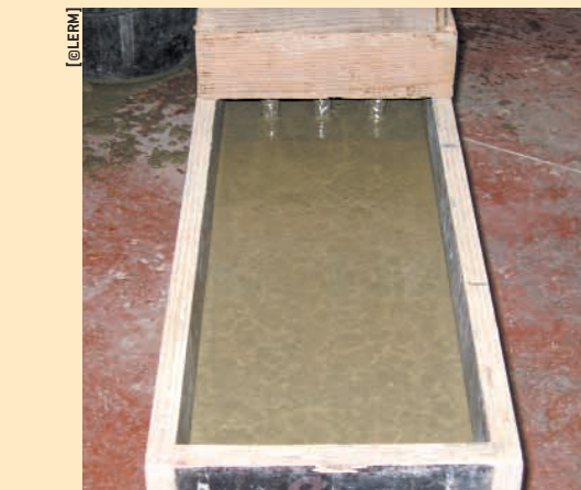
Mesure de la mobilité du béton en milieu confiné à la boîte en L.
