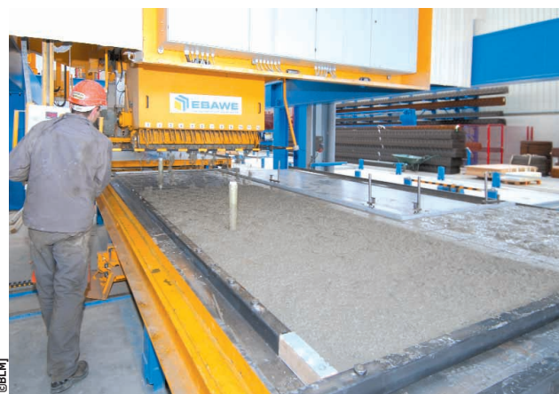
La production s'organise autour de la technique du carrousel, installée ici par Progress Ebawe.
